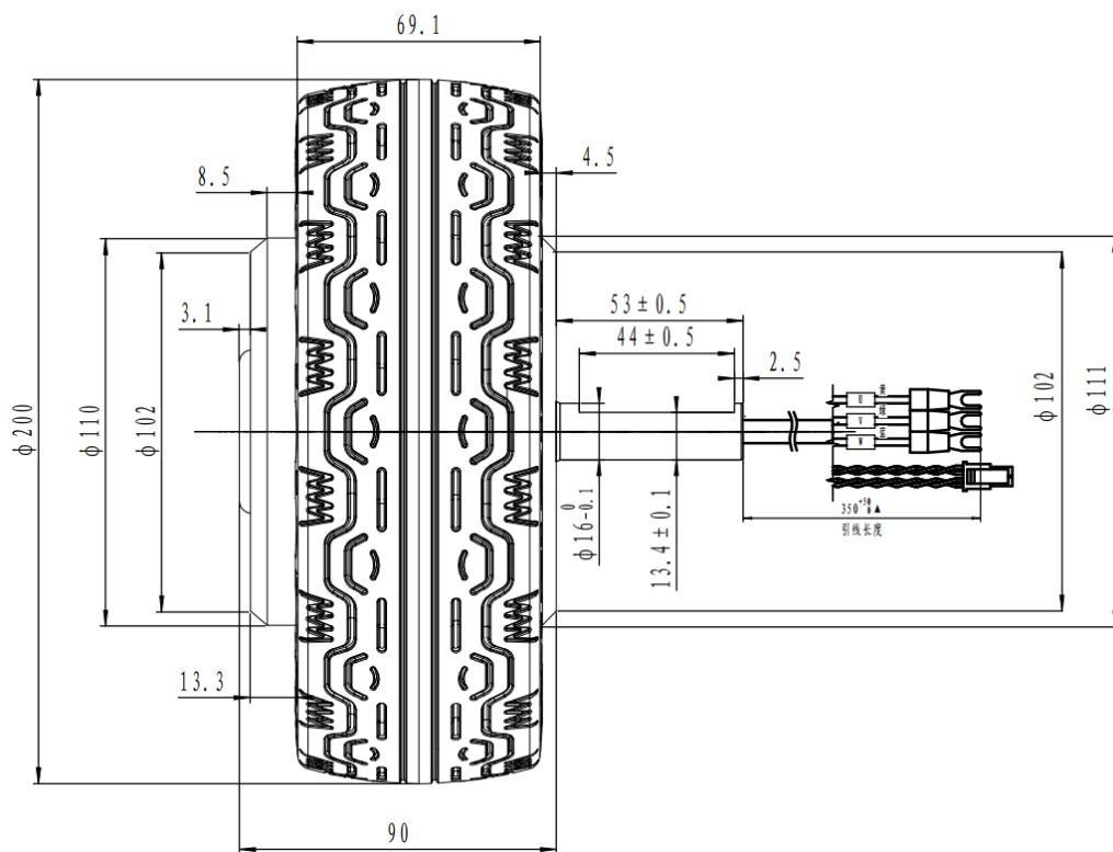
图 3.1-6 8寸 10Nm 轮毂电机安装尺寸
