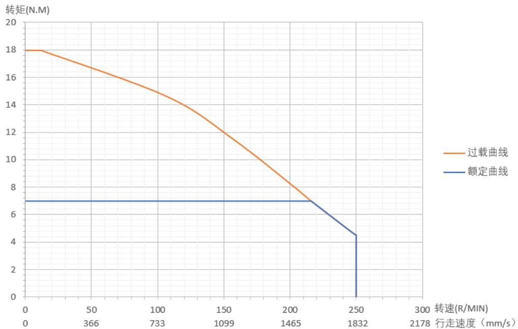
图 2.1.2-1 5.5 寸 7Nm 轮毂电机特性曲线
