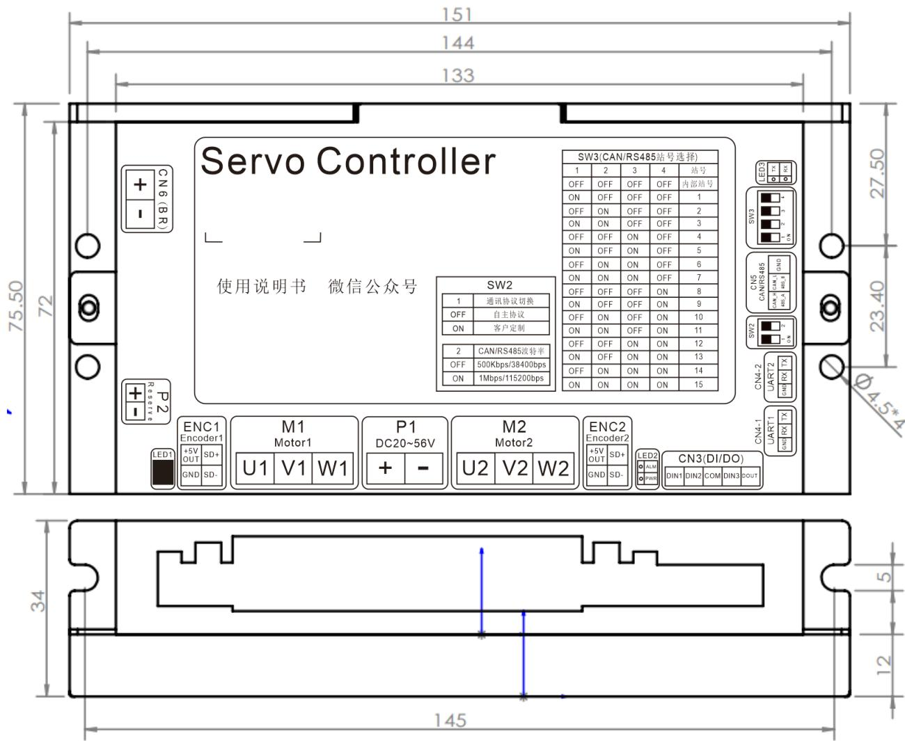
图 3.1-1 L2DB4830 伺服驱动器安装尺寸
