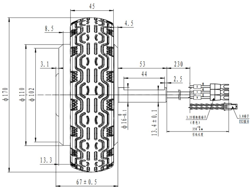
图 3.1.4 6.5寸轮毂电机安装尺寸
