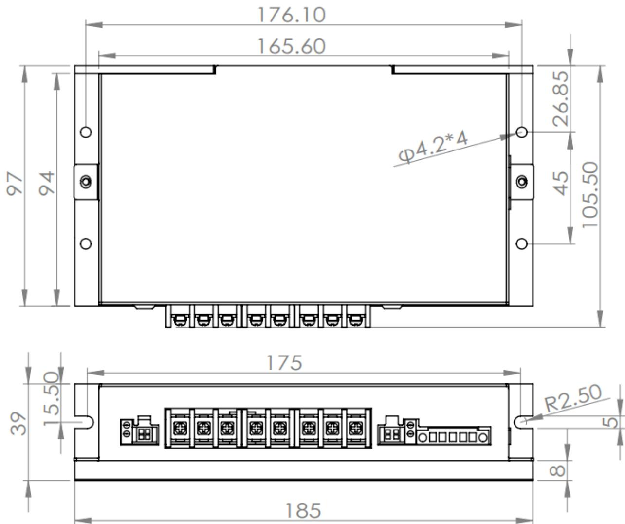
图 3.1-2 L2DB4875 伺服驱动器安装尺寸
