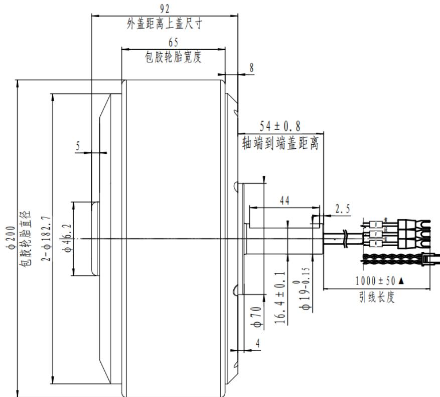
图 3.1-9 8寸 30Nm 轮毂电机安装尺寸
