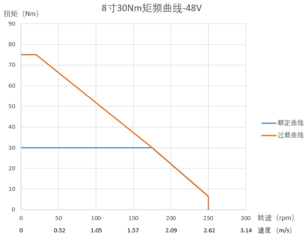
图 2.1.8-1 8寸 30Nm 轮毂电机特性曲线
