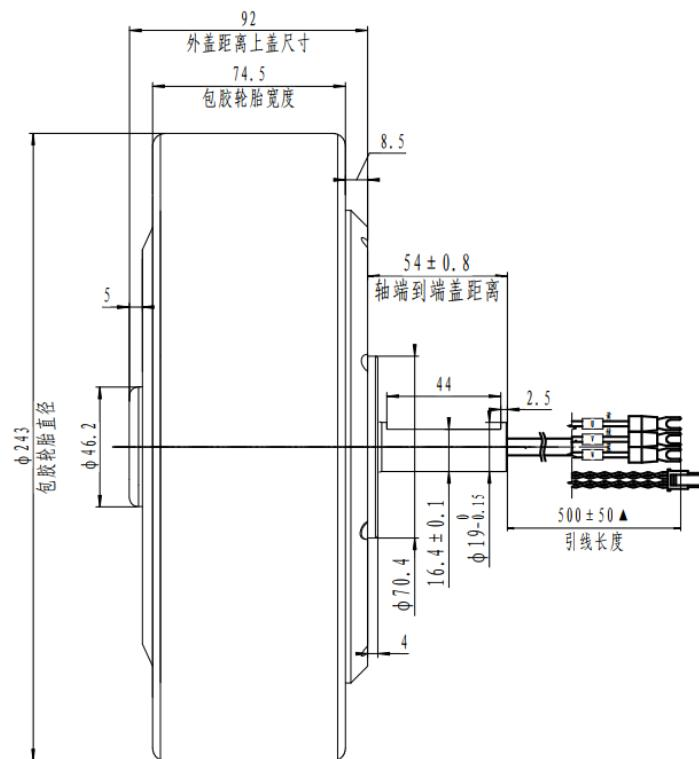
图 3.1-10 10寸 30Nm 轮毂电机安装尺寸
