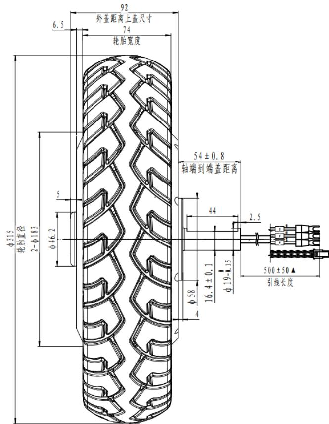
图 3.1-11 12 寸 30Nm 轮毂电机安装尺寸
