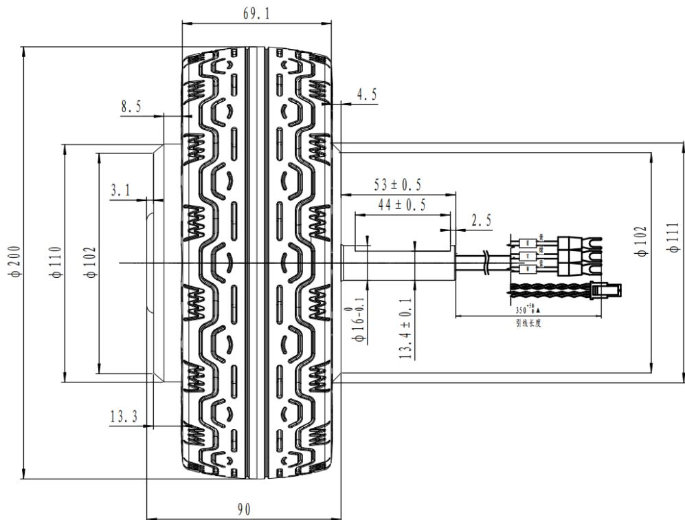
图 3.1-8 8 寸 15Nm 轮毂电机安装尺寸
