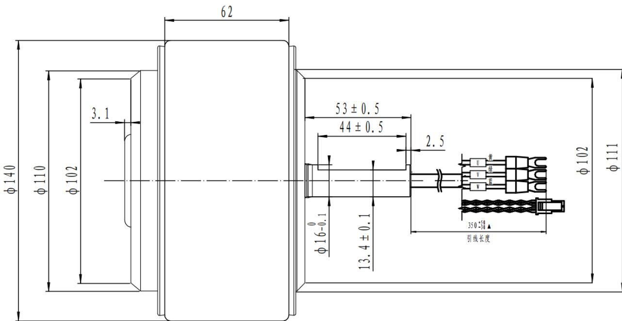
图 3.1-7 5.5 寸 15Nm 轮毂电机安装尺寸
