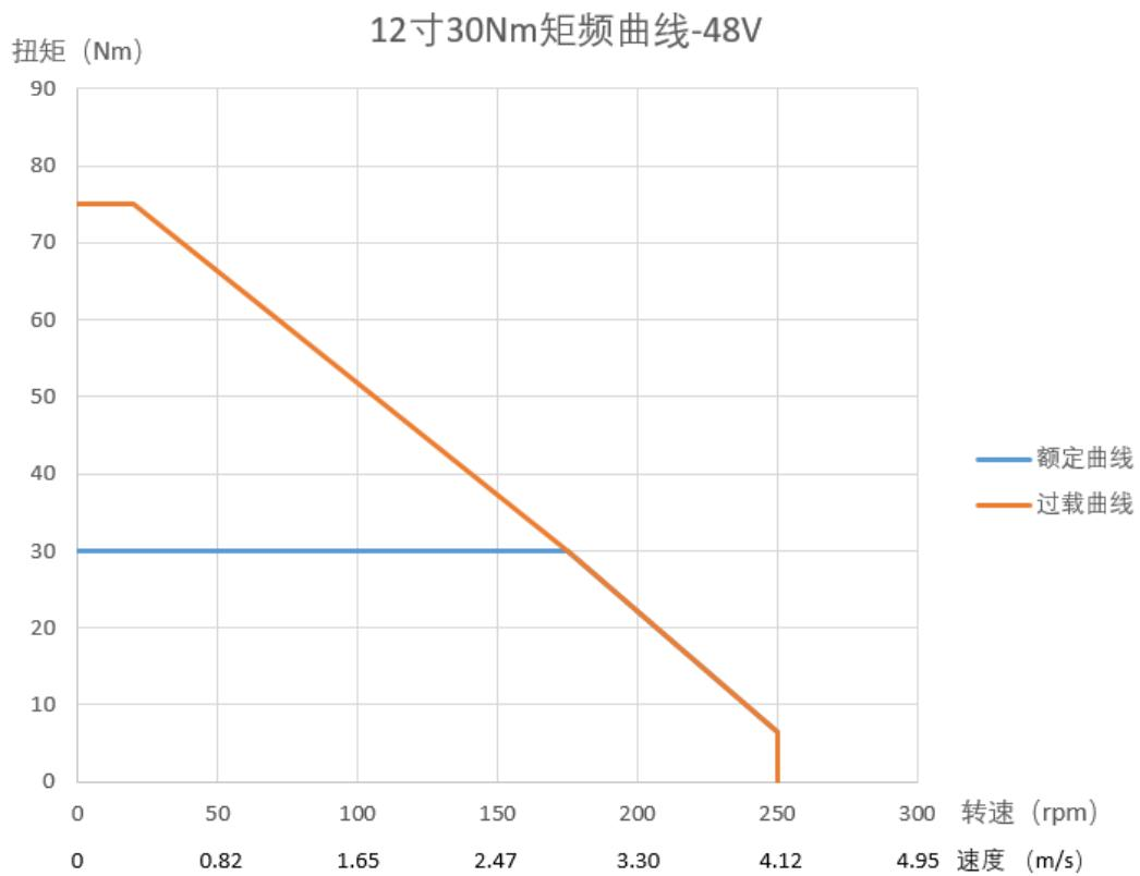
图 2.1.10-1 12 寸 30Nm 轮毂电机特性曲线
