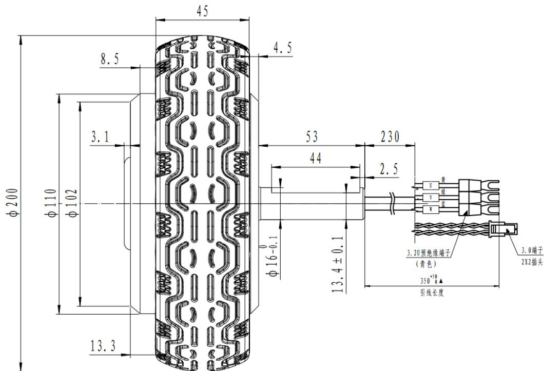
图 3.1-5 8寸 7Nm 轮毂电机安装尺寸
