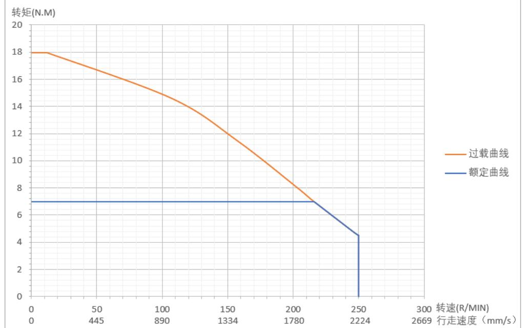
图 2.1.3-1 6.5 寸 7Nm 轮毂电机特性曲线
