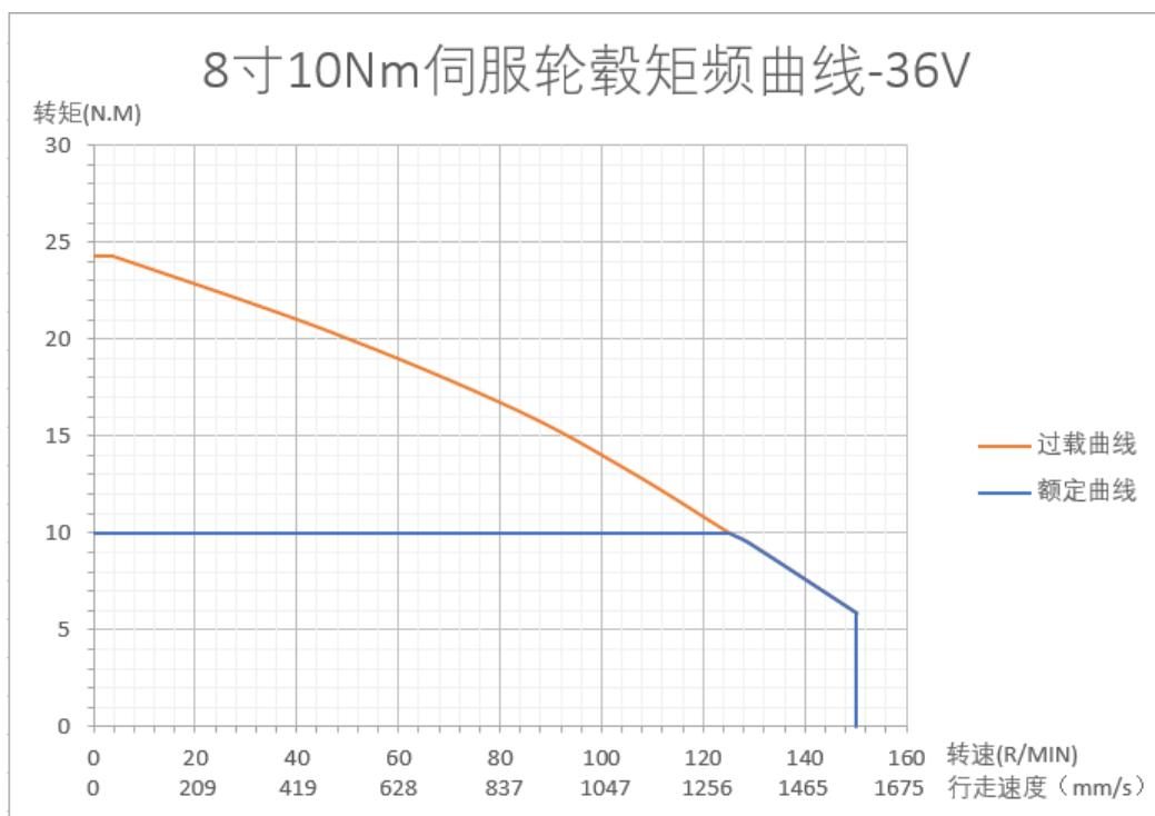
图 2.1.5-1 8寸 10Nm 轮毂电机特性曲线
