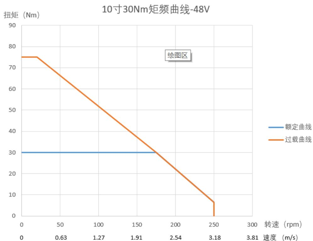
图 2.1.9-1 10寸 30Nm 轮毂电机特性曲线
