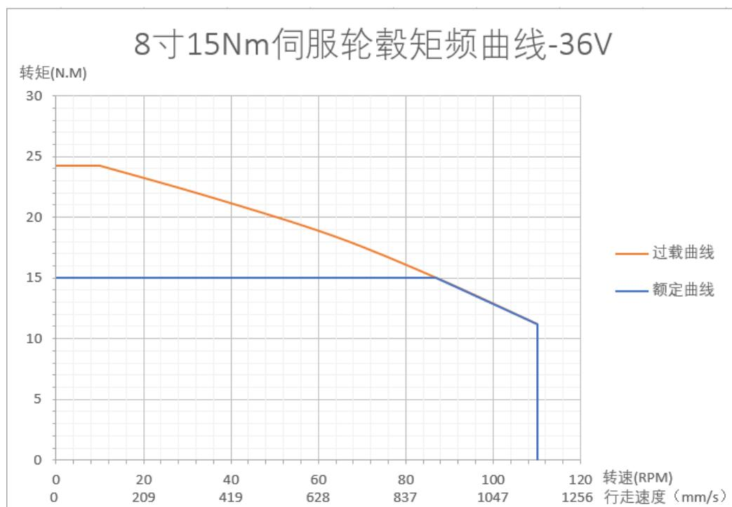
图 2.1.7-1 8 寸 15Nm 轮毂电机特性曲线
