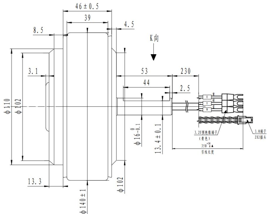
图 3.1.3 5.5寸轮毂电机安装尺寸
